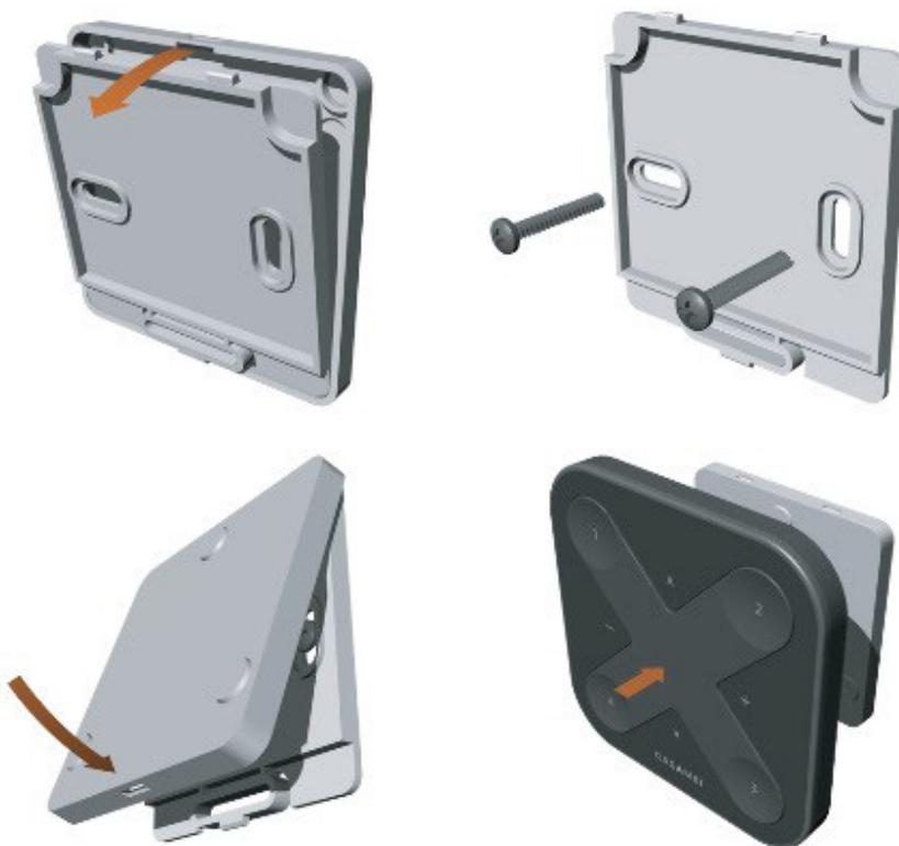
Xpress está equipado con imanes para una fácil fijación a un soporte de montaje. El soporte de montaje está incluido.
